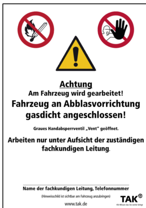
Abbildung 6-9: Kennzeichnung von Fahrzeugen mit LNG-Antrieb in der Werkstatt; Quelle: ZDK
