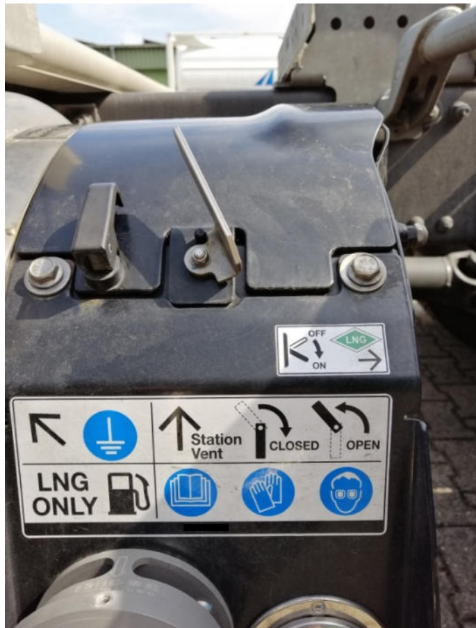
Abbildung 6-8: "Station Vent" - Ventil am Tank; Quelle: ZDK
