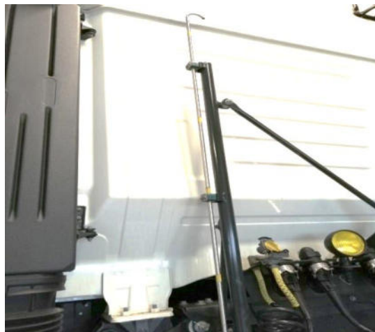
Abbildung 5-1: Abblaslanze hinter dem Führerhaus; Quelle: ZDK
