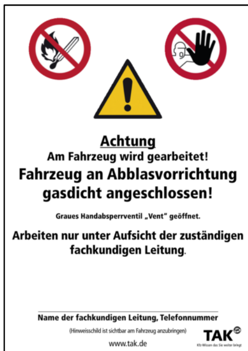
Abbildung 6-4: Kennzeichnung von Fahrzeugen mit LNG-Antrieb in der Werkstatt; Quelle: ZDK
