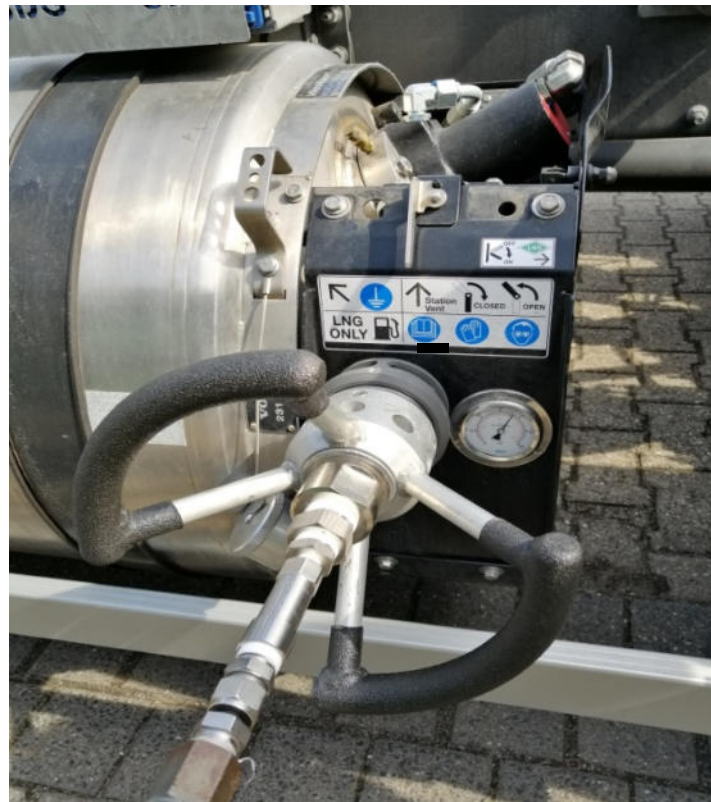
Abbildung 6-7: Anschluss der Abblasvorrichtung; Quelle: ZDK
