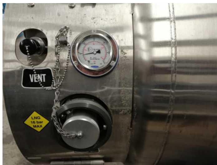
Abbildung 4-3: LNG-Tank (Kryotank); Quelle: ZDK
